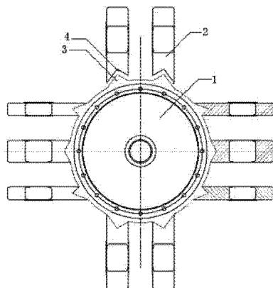
1. 一种六面顶压机铰链梁，包括缸体和耳朵，其特征是，所述的缸体外部与耳朵连接处设置有棱脊，所述的耳朵上设置有与棱脊相配合的凹槽，二者为焊连接。
