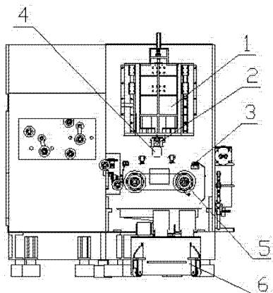
1. 金刚石线单棒多线切割机,它包括全部采用模块化的绕线装置、加工装置、电器控制器、切削液循环供给装置、切削液循环冷却装置和气动保护装置,所述绕线装置和加工装置分别为独立模块,所述加工装置由机头组件和槽轮组件组成,所述机头组件包含工件进给机构(1)、伺服驱动器和工件夹紧机构(2),所述槽轮组件包括两个主槽轮(5),其特征是:所述主槽轮中心距为440mm-460mm。
